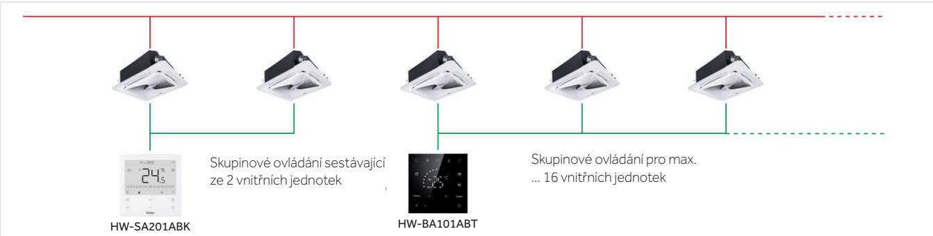
Příklad skupinového ovládání (pouze pro kabelové ovladače - max. 16 vnitřních jednotek na jednom ovladači)
