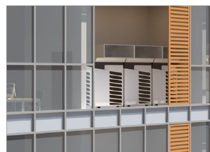
Ukryté venkovní jednotky uvnitř budovy
